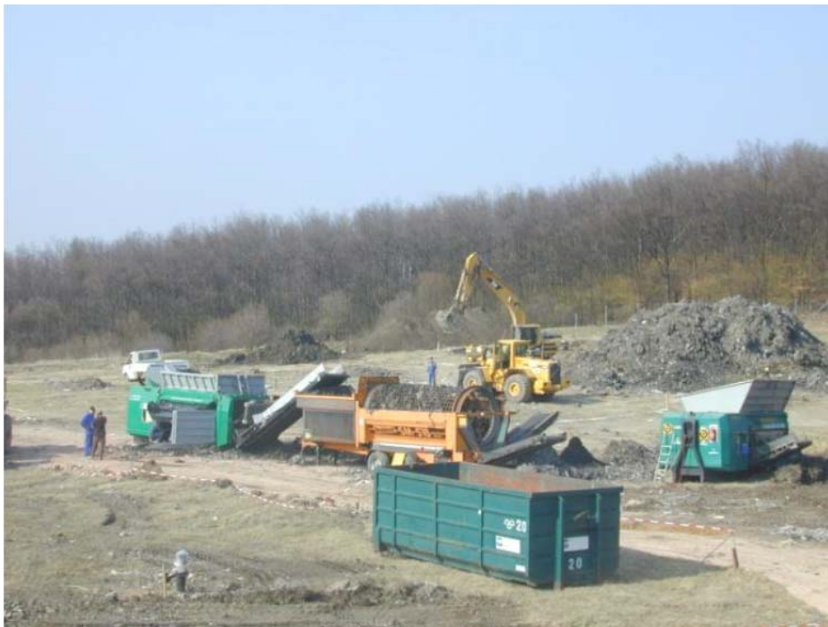
Abbildung 2: Mobiler Immobilisierungszug bestehend aus Schredder, Trommelsieb und Mischanlage
