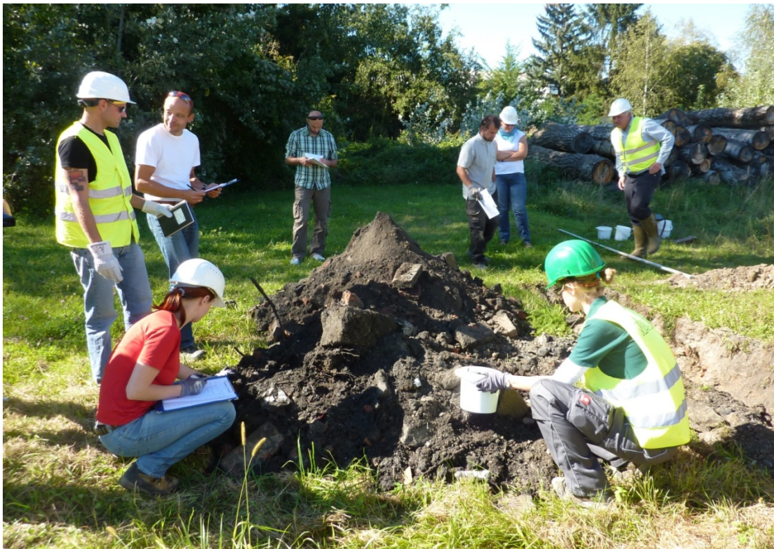
Abbildung 1: Feststoffprobenahme aus einem Baggerschurf
