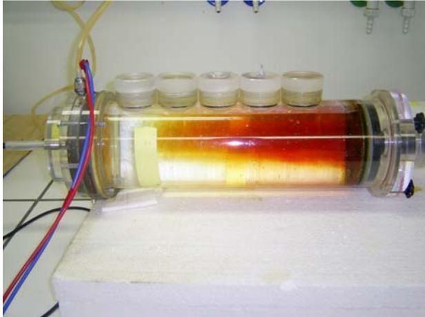
Abbildung 1: Transport von Oxidationsmittel in wässriger Phase.
